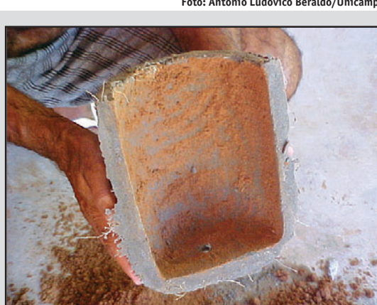
O bioconcreto, mistura de cimento, areia e partículas de bambu, madeira, bagaço de cana ou casca de arroz, dá forma a jardineiras, telhas onduladas e coletores solares
